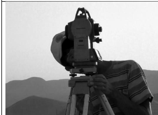
5. 水平になってかつ測点の真上に機械の中心軸がくるように調整する。
