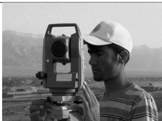
4. 調整ネジを回して機械が水平になるように調整する。
