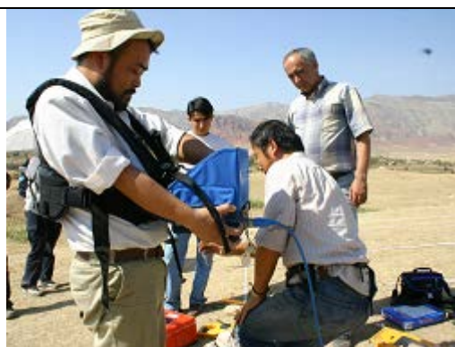
10月9日 地中レーダーのオペレーター部分 小野田氏がベルトで装着して操作 小林寛氏撮影
