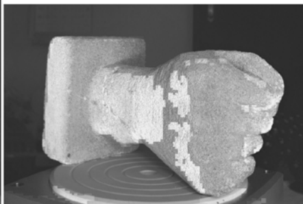
NextEngineによるスキャニング ターンテーブル上のオブジェクト 右：縦軸回転で16方面をスキャン 左：横軸回転で16方面をスキャン
